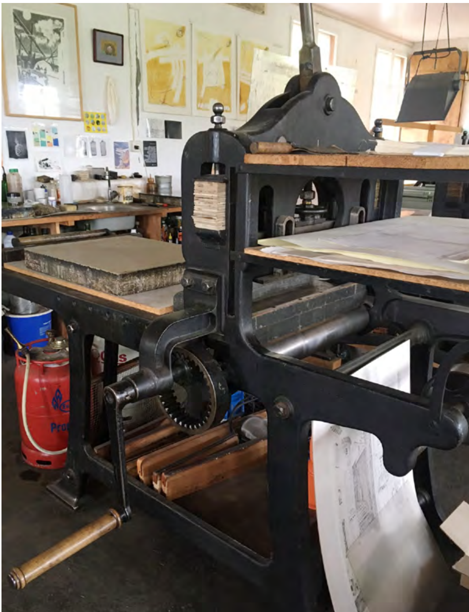
In dieser Handpresse wird der Lithostein mit der Zeichnung auf einem Schlitten unter einem Reiber durchgezogen und der Abzug (seitenverkehrt) auf das Papier gebracht. Fotos: Urs Graf.
